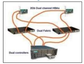
E' implementato l'utilizzo di storage in SAN con meccaniche completamente ridondate abilitando così caratteristiche di prestazioni ed affidabilità anche per le applicazioni più critiche.
